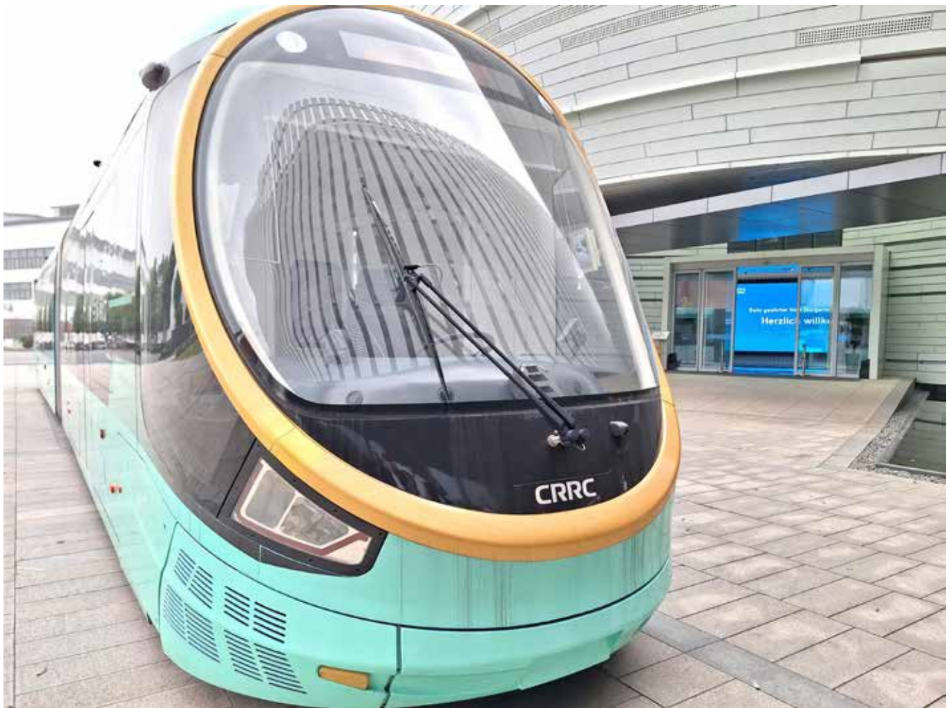
Die Straßenbahn fährt auf Rädern und wird durch Sensoren im Fahrzeug und Markierungen auf der Straße gesteuert.
